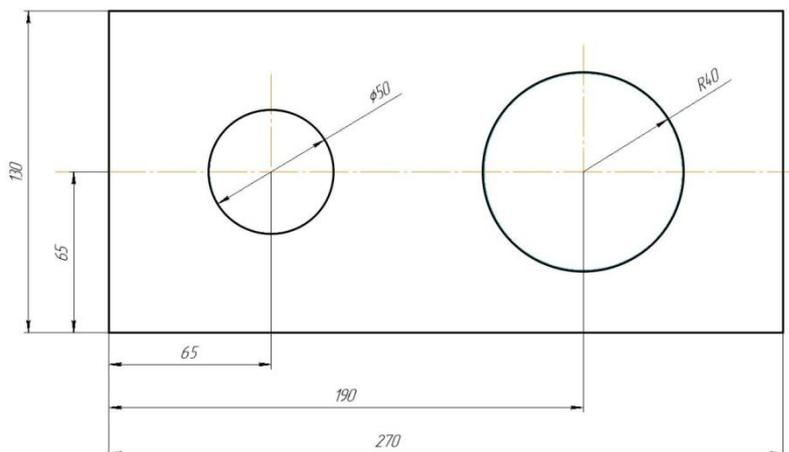
Определите площадь (в квадратных сантиметрах) одной стороны детали. При расчётах примите  $\pi \approx 3,14$ . Ответ округлите до целого. Для получения более точного результата, округление стоит производить только при получении финального ответа.
