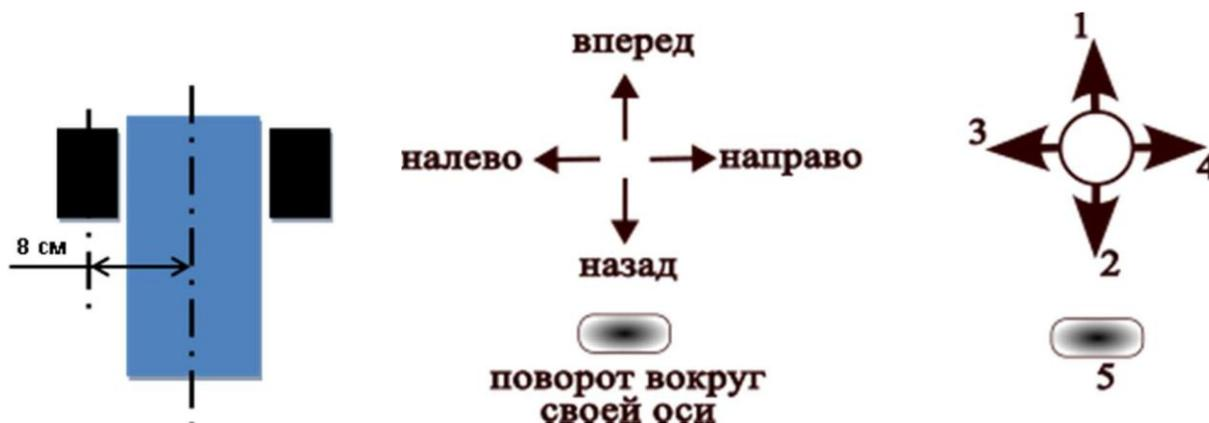
«ROBO-1» одновременно может выполнять только одно из пяти возможных действий. В зависимости от того, какое положение на пульте управления будет занимать джойстик и нажата или нет кнопка, робот будет выполнять определенные действия (смотрите Таблицу №1).
