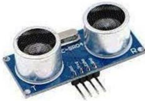
Принцип его работы следующий: датчик генерирует импульсы с частотой 40 кГц, которые через излучатель направляются в прямом направлении, при наличии впереди препятствия, они отражаются от него, и уже отражённый сигнал принимается приёмником. Данный датчик расстояния следует отнести к радиоэлектронному устройству, определяющему расстояние на основе –
