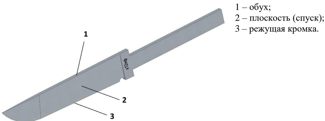
Рис. 3. Упрощенный вид изделия – устройство лезвия ножа
