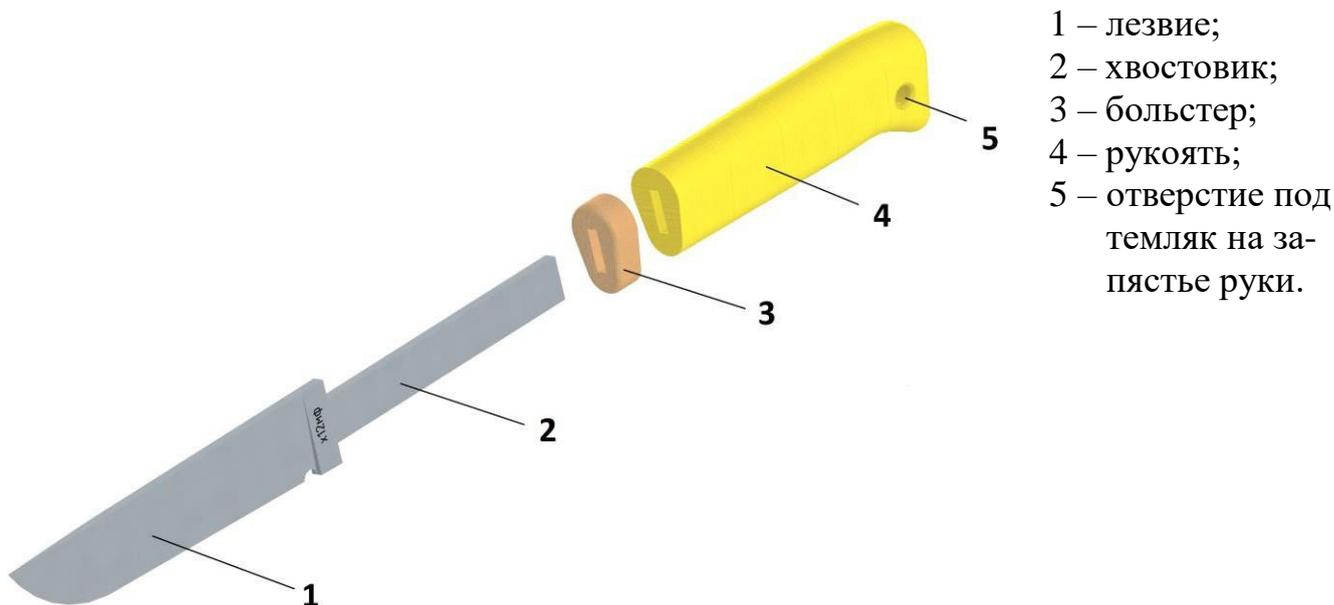
Рис. 2. Упрощенный вид изделия – образец в разобранном виде
