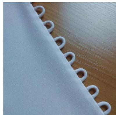
Обтачной шов с навесными петлями используется при обработке застежек из шнура, тесьмы или полоски ткани.
